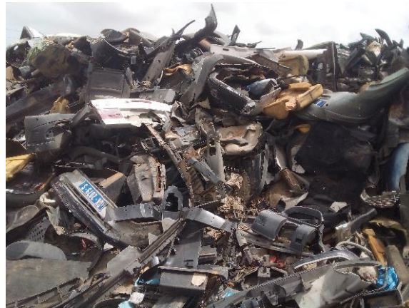
Photo 13 : Matières non métalliques issues du démantèlement des véhicules
