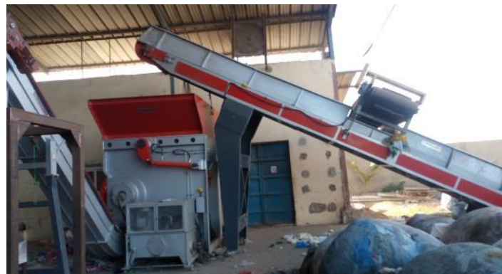
Photo15 : Déchiqueteur lent alimenté par convoyeur
